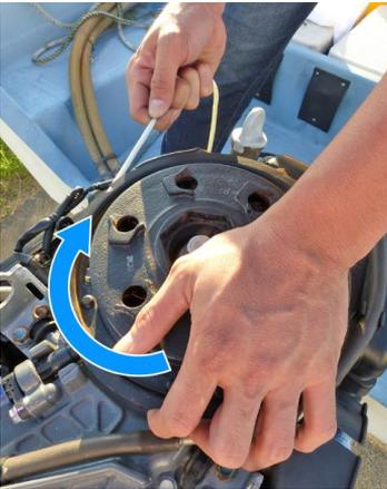
10. Wickeln Sie die Notstartsnur entlang der Nut im Rotor des Wechselstromgenerators im Uhrzeigersinn um das Schwungrad.
