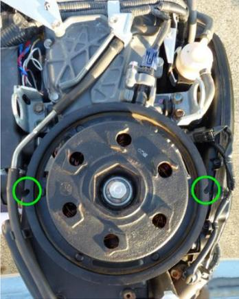
8. Drehen Sie den Rotor des Wechselstromgenerators im Uhrzeigersinn, sodass sich die Aussparungen auf der rechten und linken Seite des Rotors des Wechselstromgenerators befinden, wie in der Abbildung dargestellt.
