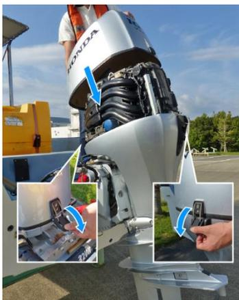
14. Lassen Sie die Abdeckung des Wechselstromgenerators weg, und setzen Sie die Motorabdeckung auf. Schließen Sie die Befestigungsschnallen der Motorabdeckung.
