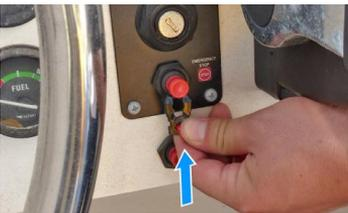
11. Setzen Sie den Nothaltschalterclip am Nothaltschalter ein. Bringen Sie das andere Ende des Nothaltschalter-Bands fest am Bediener an.
