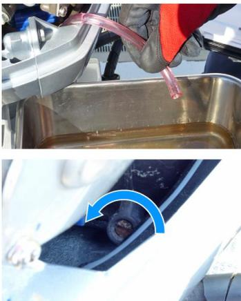
5. Lösen Sie die Ablassschraube des Dampfabseiders. Fangen Sie das Benzin mit der Auffangwanne auf, sobald es aus dem Ablassrohr herausläuft.
