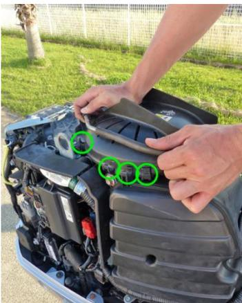
3. Lösen Sie den Entlüftungsschlauch von den vier Klemmen.
