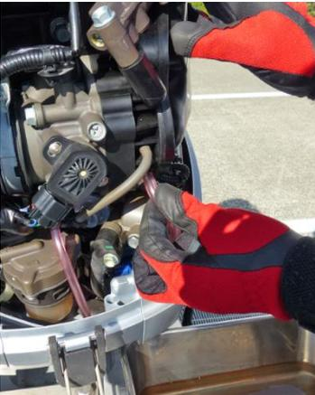
7. Befestigen Sie das Ablaufrohr wieder am Vorsprung des Einlassstutzens.
