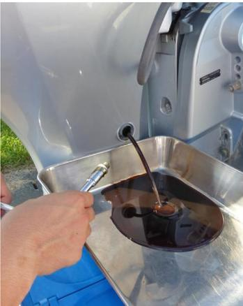
10. Stellen Sie einen geeigneten Behälter unter die Ölablassöffnung, entfernen Sie die Motorölablassschraube und die Unterlegscheibe. Lassen Sie das Altöl solange laufen, bis es nur noch herauströpfelt.
