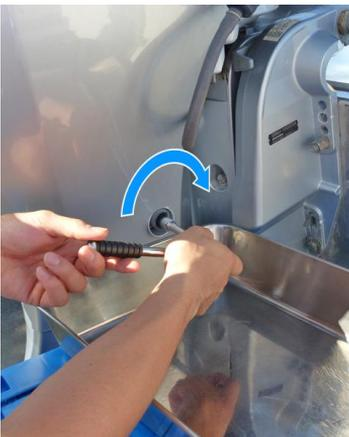
11. Montieren Sie nach dem Ablassen des Öls die Ablassschraube und die neue Dichtungsscheibe und ziehen Sie die Schraube fest an.
