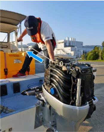
16. Ziehen Sie mehrmals an der Notstartschnur, um das Innere des Zylinders zu schmieren. Entfernen Sie anschließend die Notstartschnur. Einzelheiten zur korrekten Verwendung der Notstartschnur entnehmen Sie dem Kapitel „Falls das Zündsystem nicht funktioniert“.
