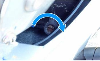
6. Ziehen Sie nach dem Entleeren die Ablassschraube fest an.
