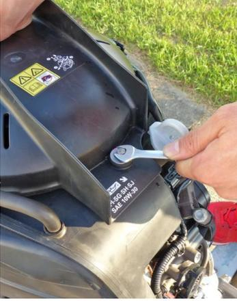
4. Entfernen Sie den Flanschbolzen und die Unterlegscheibe, entfernen Sie dann die Lichtmaschinen-Abdeckung.
