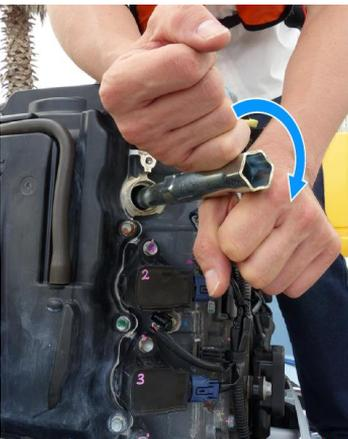
17. Drehen Sie die Zündkerzen vorsichtig von Hand ein, um ein Ausreißen des Gewindes zu vermeiden. Ziehen Sie die Zündkerzen nach dem Aufsitzen mit einer 1/8- bis 1/4-Drehung fest. Bringen Sie die Lichtmaschinen-Abdeckung wieder an.
