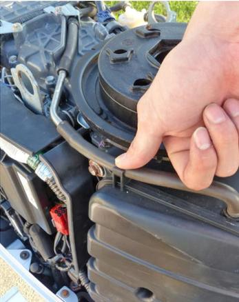
5. Befestigen Sie den Entlüftungsschlauch an der Klemme des Schalldämpfergehäuses.
